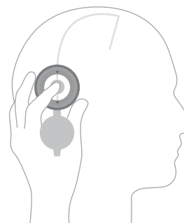
Fig. 9: localizzazione della valvola con la bussola M.blue plus
