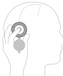
Abb. 9: Lokalisieren des Ventils mit dem M.blue plus Kompass
